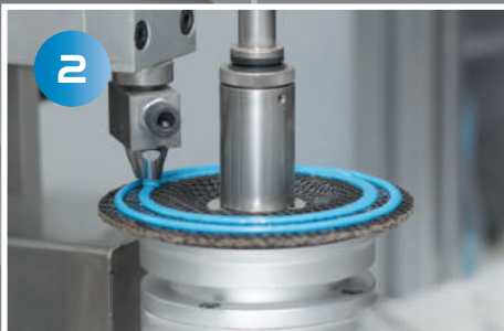
2 Точная дозировка при нанесении термостойкого клея
